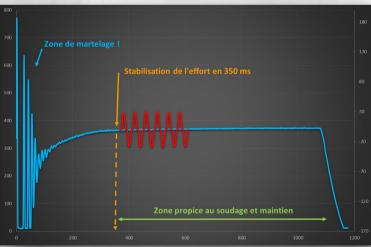
Mise à disposition de nos experts et appareils de mesures pour vous aider dans l'analyse de vos productions en terme de qualité soudage et répétabilité sur machines ARO, Tecna, Sciaky, Miyachi...
